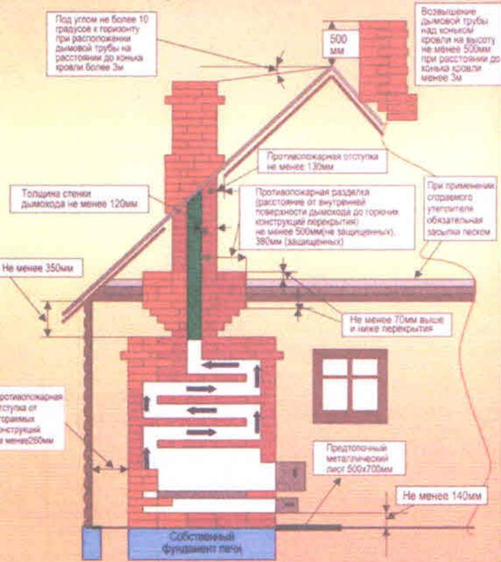
должны иметь утолщения кирпичной кладки - распушку. Не нужно забывать и про утолщение стенок печи. Длястыковки массива печи с деревянными перегородками применяется противопожарная разделка.
